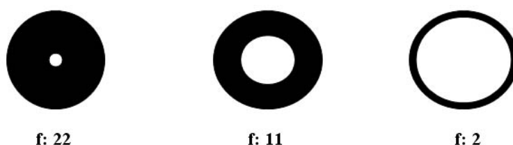
Fig. 24 - Abertura do diafragma e variação dos valores f.
